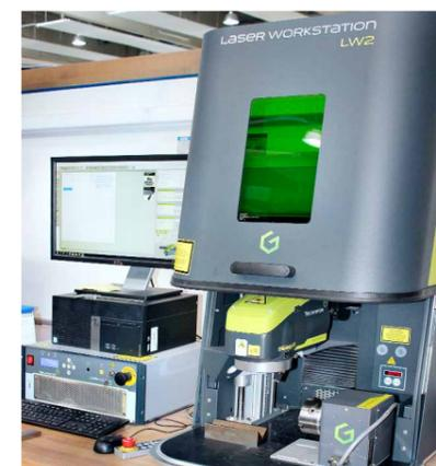
Mit dem LW2 steht dem Anwender ein kompletter und erweiterbarer Einzelarbeitsplatz zur Verfügung. Dank der automatischen Positionierung lassen sich Teile aller Art problemlos markieren.
