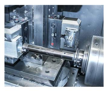
Der Smart Damper von Big Kaiser minimiert die Auswirkungen von hochfrequenten Schwingungen, absorbiert Schwingungen effektiv und ermöglicht eine höhere Bearbeitungsgenauigkeit.
