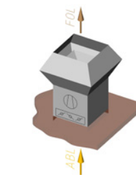
Abluft mechanisch über das Dach
