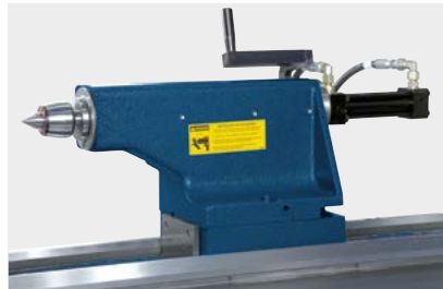
◀ Manueller Reitstock mit hydraulischer Pinole (optional)
