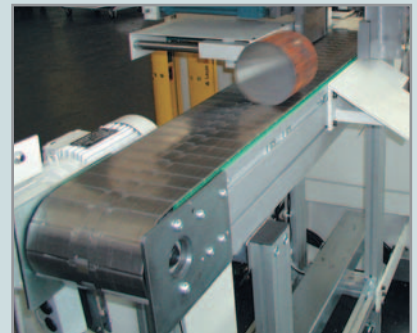
Schmierband-Kettenförderer Für längere Abschnittlängen empfehlen wir eine Entsorgungszange in Verbindung mit einem Kettengliederband und/ oder einer Rollenbahn mit Sortierpositionen
