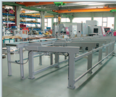
Stangenlademagazin Automatisches Beschicken von Rundstangen
