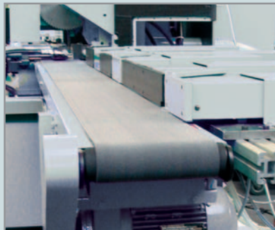
Entsorgungsband Eine oder mehrere Entsorgungs- oder Puffersta- tionen je nach Anwendungsfall. Übergabe z. B. Bür- sten-Entgratung, Ofen, Roboter etc., Kennzeich- nung der Abschnitte z. B. Signieren, Stempeln etc.
