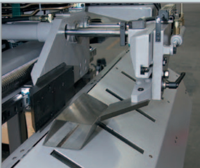
Abkippbare Rollenbahn Zum Aussortieren von Anschnitt und Reststück mit Sortiereinrichtung (vorne und hinten) und zur Übergabe an nachgelagerte Einrichtungen
