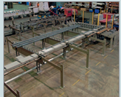
Flachmagazin Automatisches Beschicken von unterschied- lichen Profilformen - der Generalist
