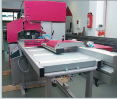
Elektronisches Längenmess-System ELA-P mit integrierter vollautomatischer Nachschubzange
