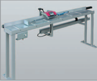
Elektronischer Längenanschlag mit verfahrbarem Messsystem, Messfehlerkompensation und Freifahren nach jedem Schnitt
