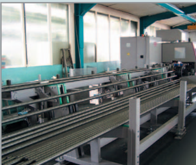
Bundlademagazin Automatisches Beschicken verschiedenster Materialformen
