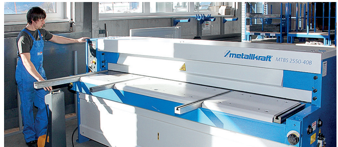
Die motorische Tafelblechschere MTBS 2550-40 B von METALLKRAFT ist mit einem NC-gesteuerten Hinteranschlag ausgestattet und über eine mobile Fußpedalkonsole bedienbar.
