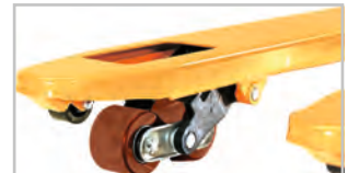
Bez.-Nr. 470-486 Tandemrollen wippend gelagert. Vorteilhaft bei unebenen Böden und Überfahren von Kanten und Schwellen. Kletterrollen an den Gabelspitzen.
