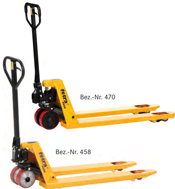
Bez.-Nr. 470-486 Tandemrollen wippend gelagert. Vorteilhaft bei unebenen Böden und Überfahren von Kanten und Schwellen. Kletterrollen an den Gabelspitzen.
