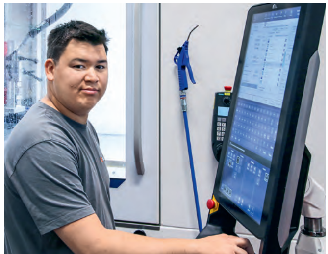
Am 24 Zoll großen Full-HD-Multitouch-Display sind die Next-Generation-Schleifmaschinen zu erkennen, die mit der neuen C.O.R.E.-Technologie ausgestattet sind.
