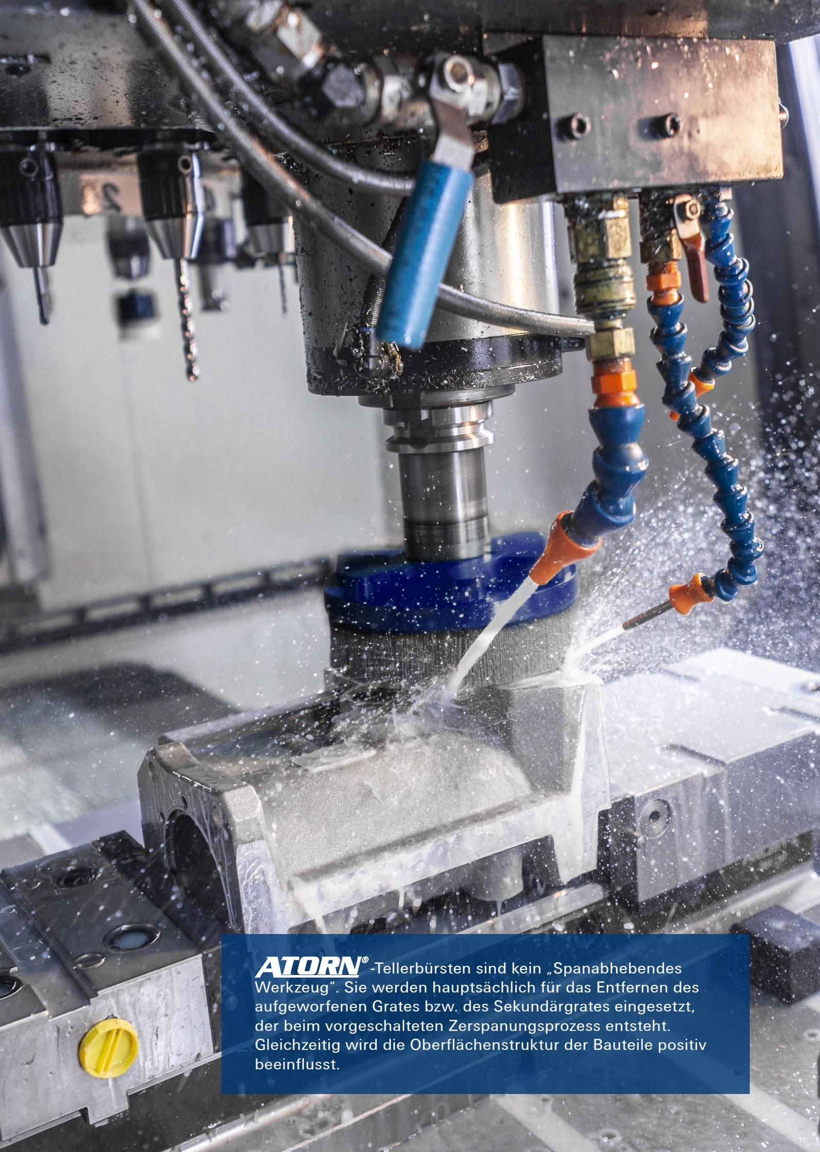
**ATORN**<sup>®</sup>-Tellerbürsten sind kein „Spanabhebendes Werkzeug“. Sie werden hauptsächlich für das Entfernen des aufgeworfenen Grates bzw. des Sekundärgrates eingesetzt, der beim vorgeschalteten Zerspanungsprozess entsteht. Gleichzeitig wird die Oberflächenstruktur der Bauteile positiv beeinflusst.
