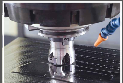
Material des Werkstücks: 1.2738 | 34-36 HRC, Formenstahl
