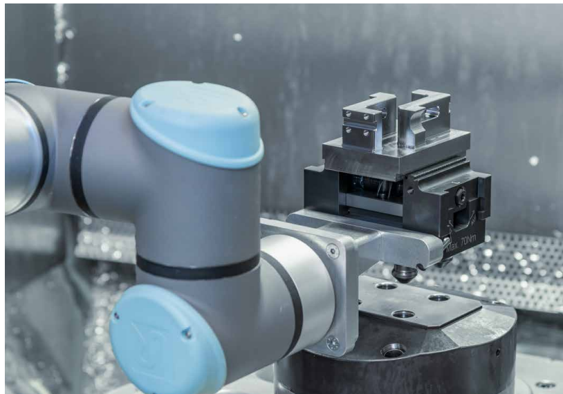
... und legt sie in die Werkzeugmaschine, nimmt die fertig bearbeiteten Teile heraus und stellt sie wieder zurück.
